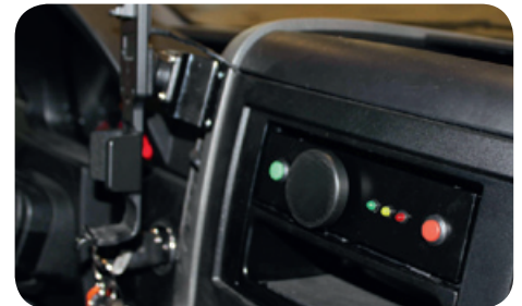
Die Starteinheit startSTOP im Armaturenbrett mit Leseinheit für den Transponder.
