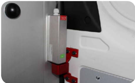
Schließeinheit snapLOG zur automatischen Verriegelung der Seiten-, Heck- und Trennwandtüren.
